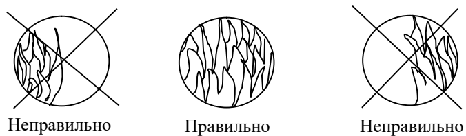
Рис. 3. Расположение датчика относительно пламени и вид на пламя через визирную трубу.
